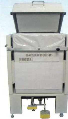
正しく段ボール箱がセットされている事を確認します。
